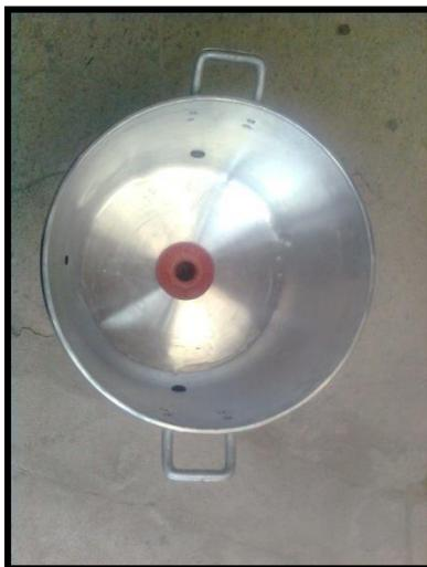
**Figura 3.14.** Orificio para descarga de leche
