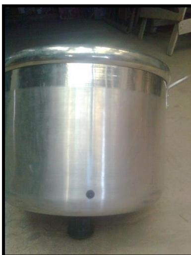
**Figura 3.13.** Orificio para sensor de temperatura
