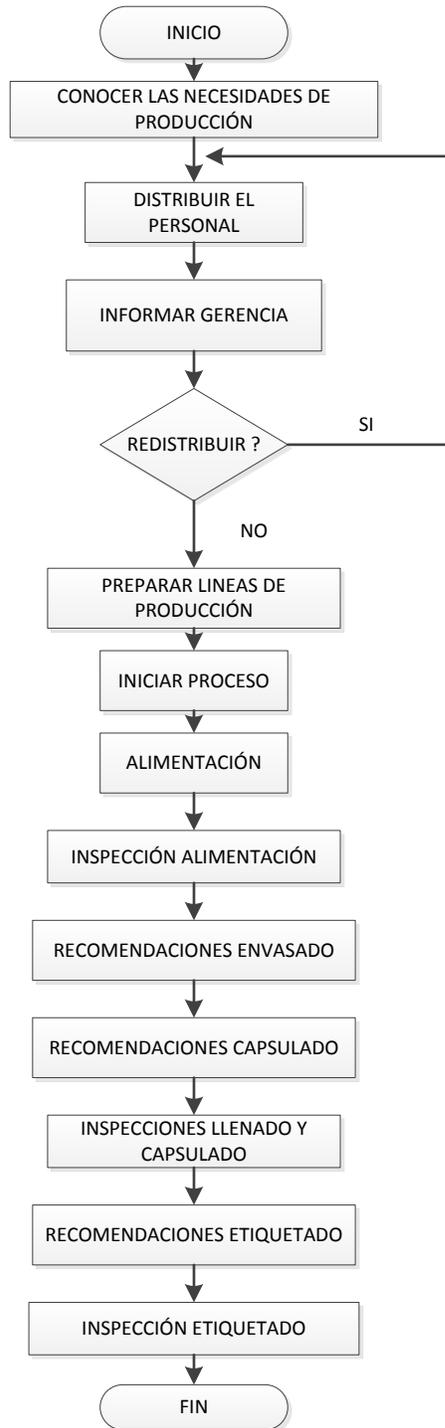
Figura 2. 4 Diagrama de flujo donde se describen las actividades del procedimiento de envasado, encapsulado y etiquetado botellas vidrio (Borelli) (LICORAM, SGC PRODUCCION Y ENTREGA, 2011)
