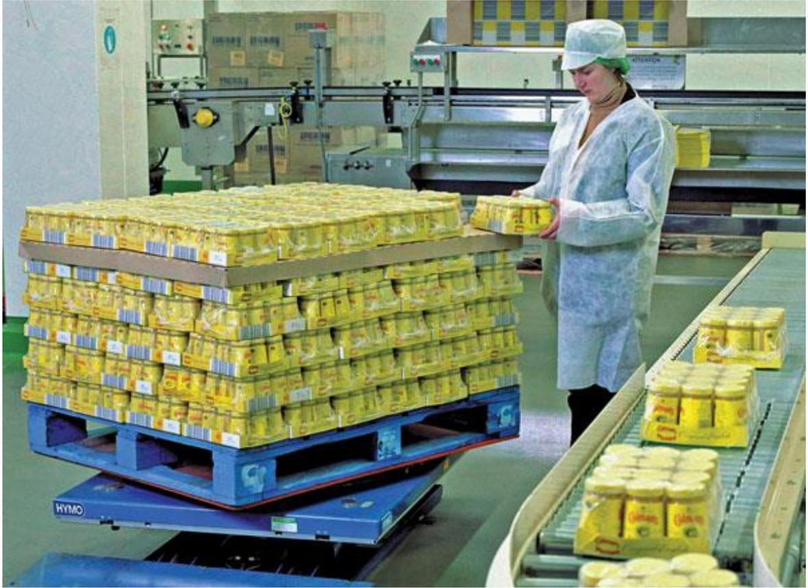
Figura 4. 9 Ejemplo de Mesa elevadora eléctrica giratoria
