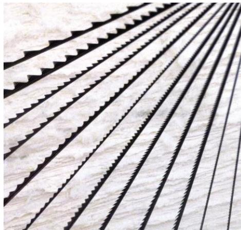
En la carda de chapones, el tipo de guarnición a base de cintas de acero con dientes de sierra; se obtiene un gran poder cardante debido a la mayor inclinación del diente y a su rigidez.
