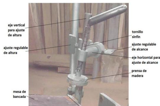
Figura 4. Mecanismo para prensar la madera.
