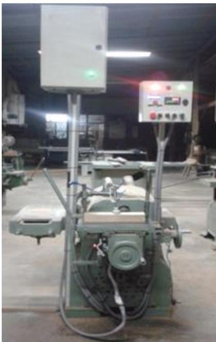
Figura 20. Máquina perforadora lineal de ebanistería modernizada.
