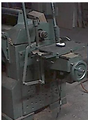
**Figura 1.** Máquina perforadora lineal de ebanistería
