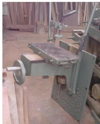
**Figura 6.** Desmontaje de bancada de la perforadora de madera.
