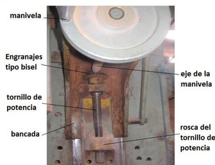
**Figura 2.** Sistema de transmisión de movimiento para el posicionamiento vertical.
