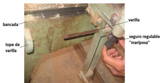
Figura 3. Sistema de tope regulable mediante “mariposa”.
