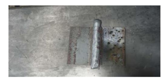
Figura 11Acabado de soldadura en borde
