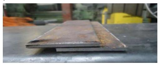
Figura 26 Soldadura tipo tapón
