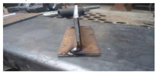
Figura 17 Soldadura con unión en T
