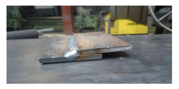
Figura 16 Acabado de soldadura de tipo solape
