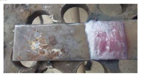
Figura 28. Relleno con proceso MIG
