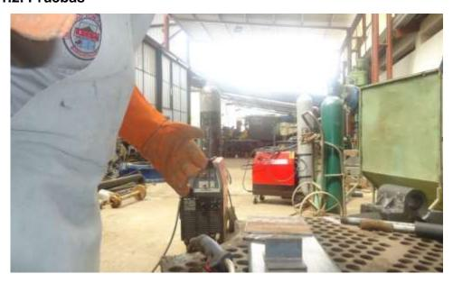
Figura 2. Equipo de soldadura MIG.
