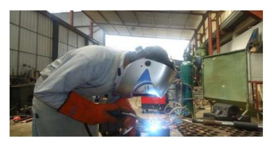
Figura 5 Soldadura MIG.
