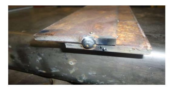
Figura 27 Acabado de soldadura tipo tapón
