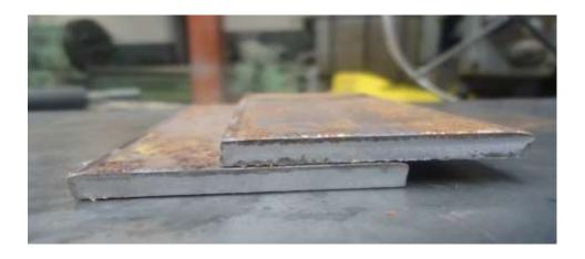
Figura 15 Soldadura de tipo solape
