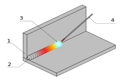
Figura 1. Soldadura MIG
