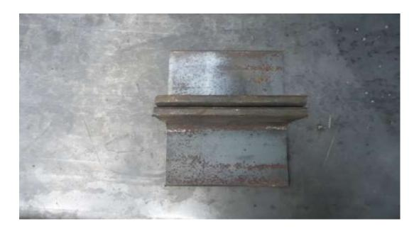
Figura 10 Soldadura en borde
