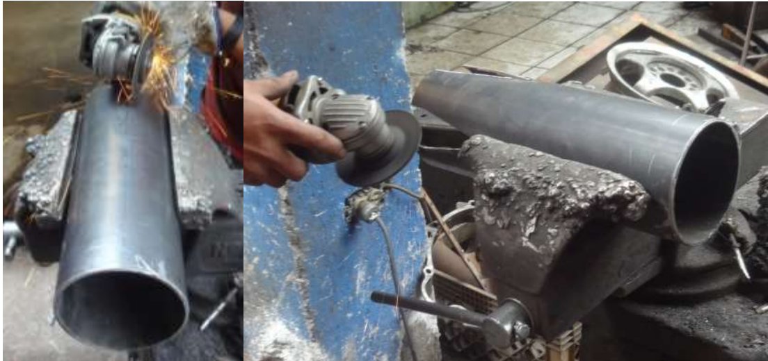
FIGURA 34: Corte del tubo de la camisa de la cámara de combustión.
