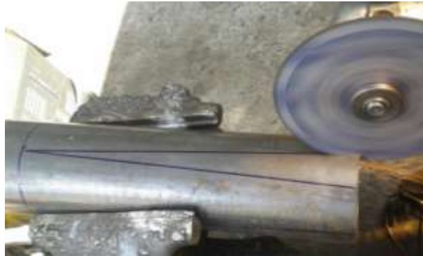
FIGURA 56: Corten de las pestañas del tubo para la tobera de escape.
