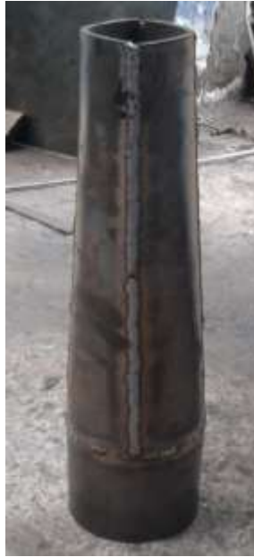
FIGURA 59: Suelta de las pestañas y base de la tobera de escape.
