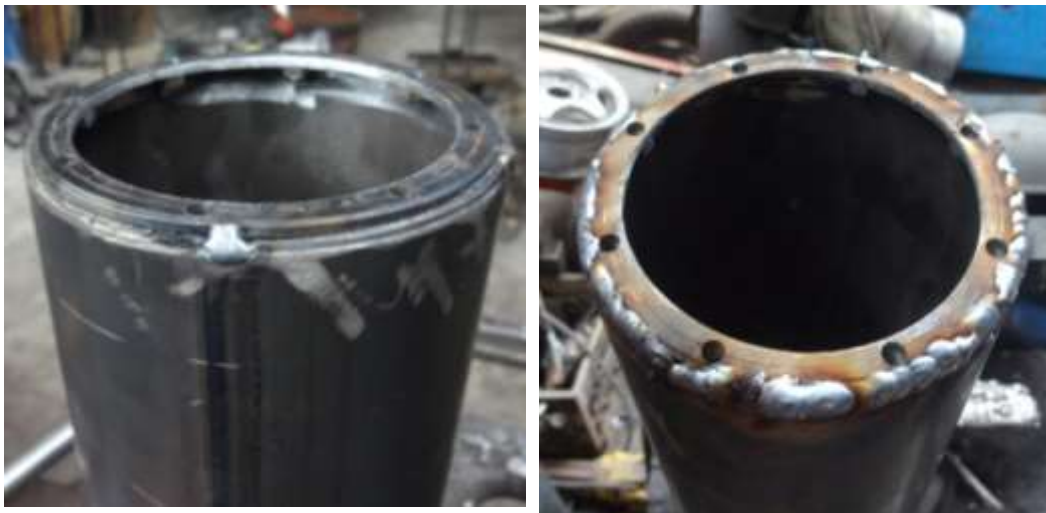
FIGURA 39: Punteado y soldadura del anillo soporte con la camisa de la cámara de combustión.
