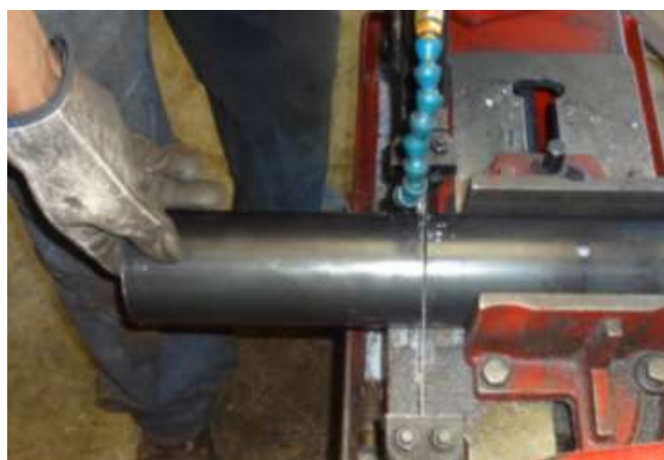
FIGURA 32: Corte del tubo de la camisa de la cámara de combustión.
