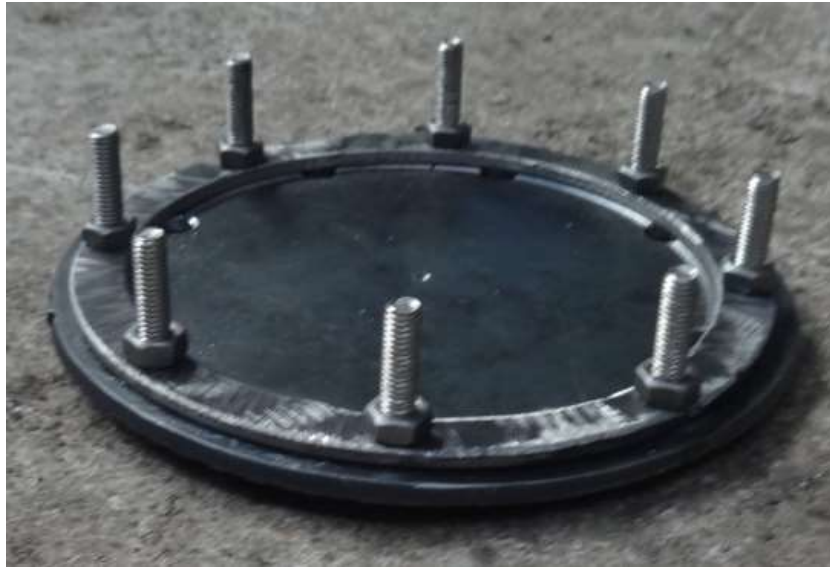
FIGURA 27: Perforación del anillo y base de la cámara de combustión.
