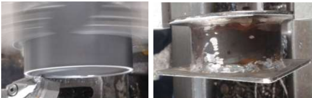
FIGURA 53: Torneado de la base de la tobera de escape.
