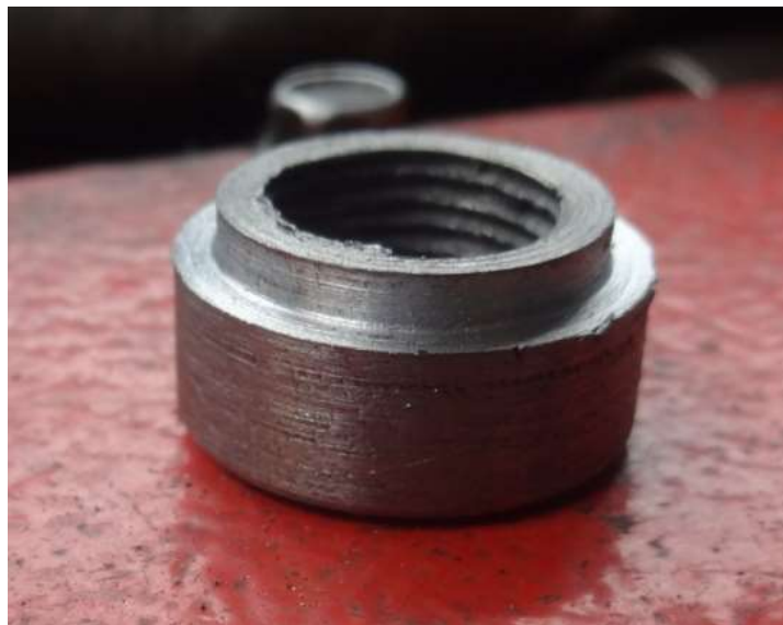
FIGURA 30: Presentación del acoplé de bujía.
