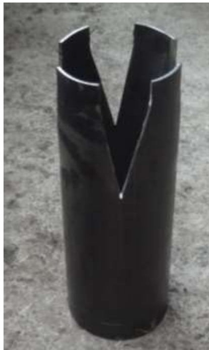
FIGURA 35: Tubo en corte de la camisa de la cámara de combustión.
