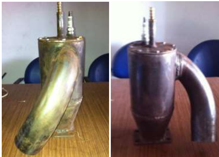
FIGURA 50: Presentación final de la cámara de combustión.
