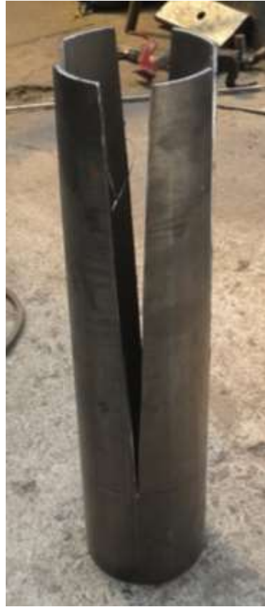
FIGURA 57: Presentación en corte del tubo para la tobera de escape.
