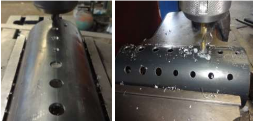
FIGURA 42: Perforación del difusor de la cámara de combustión.
