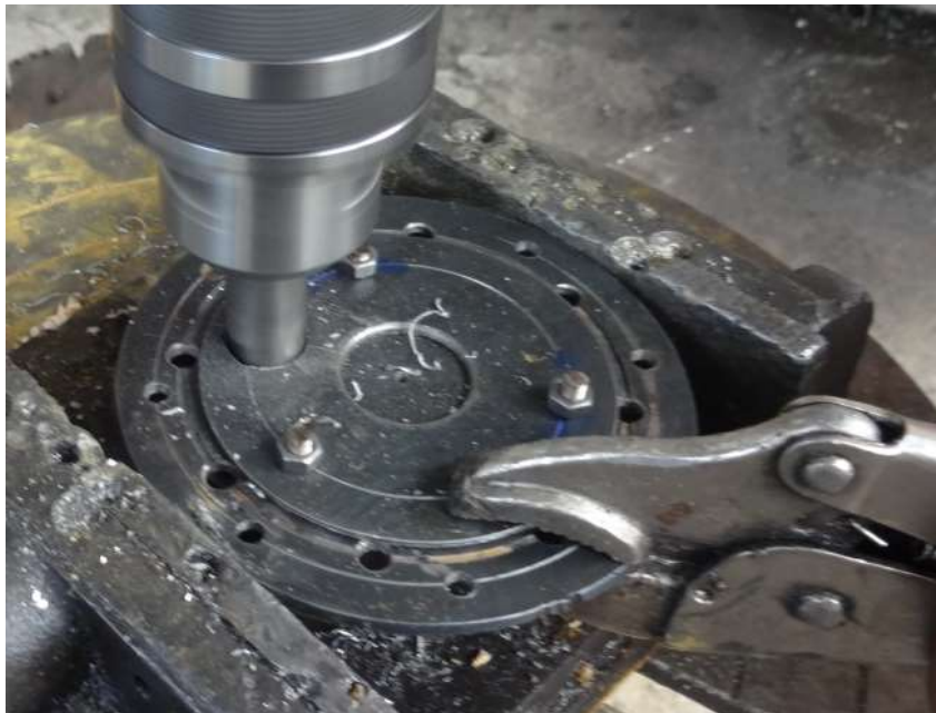
FIGURA 28: Perforación del acople de bujía.
