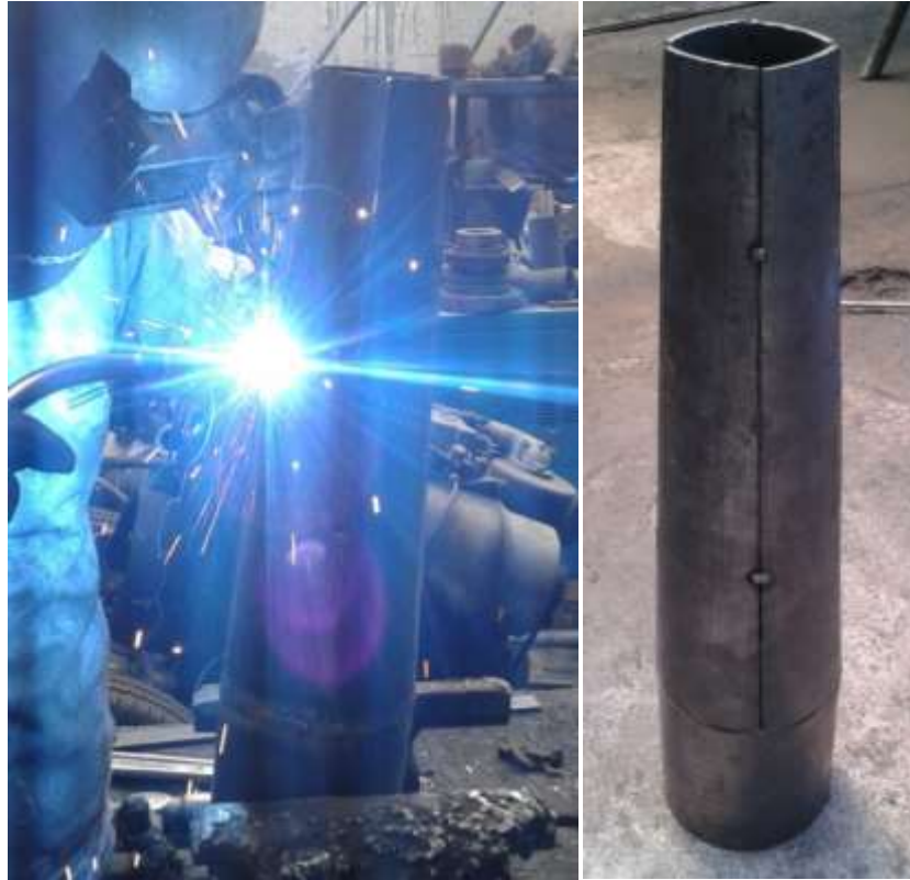
FIGURA 58: Moldeo y punteado del tubo de la tobera de escape.
