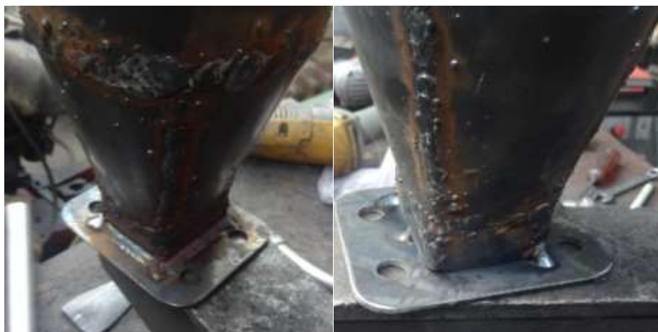
FIGURA 38: Suelda de la camisa y asiento de la cámara de combustión.
