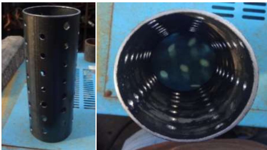
FIGURA 43: Presentación del difusor perforado de la cámara de combustión.
