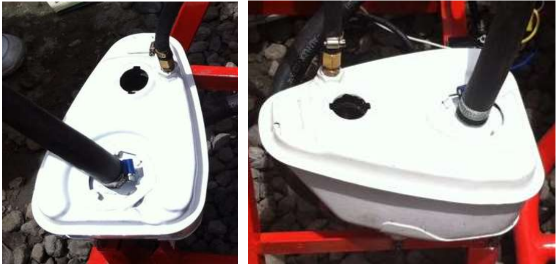
FIGURA 64: Reservorio de aceite, del sistema de lubricación y refrigeración.
