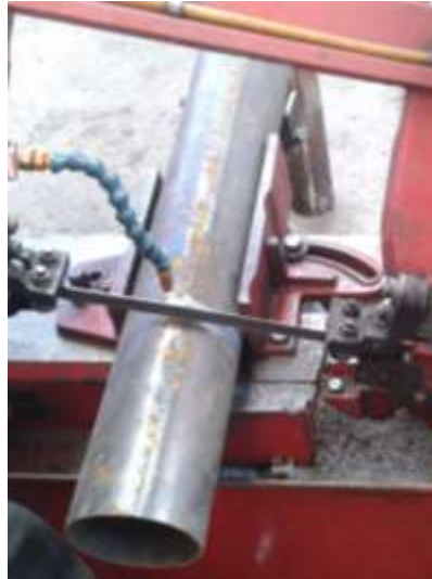
FIGURA 52: Corte del tubo para la tobera de escape.
