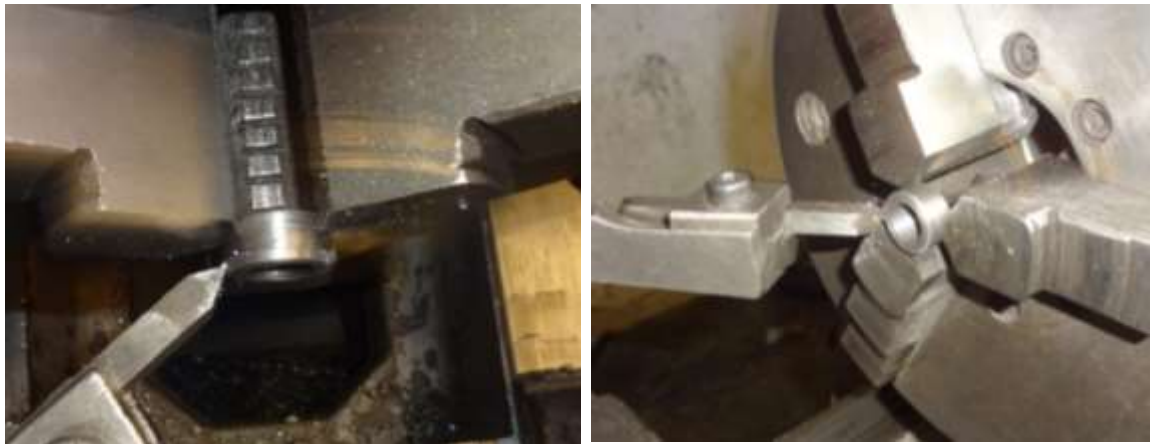
FIGURA 29: Torneado del acoplé de bujía.
