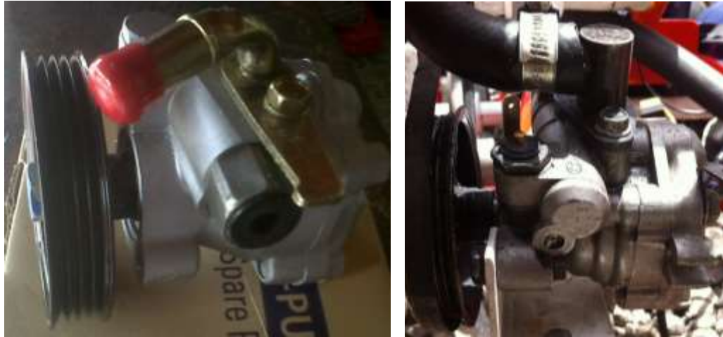
FIGURA 62: Bomba hidráulica del sistema de lubricación y refrigeración.
