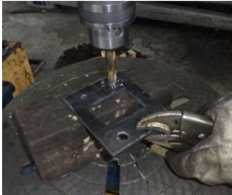
FIGURA 22: Perforación del asiento de la cámara de combustión.
