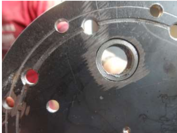
FIGURA 31: Fijación del acoplé de bujía en la base del difusor de la cámara de combustión.
