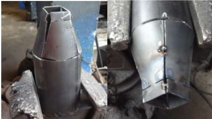
FIGURA 37: Punteado de la camisa de la cámara de combustión.
