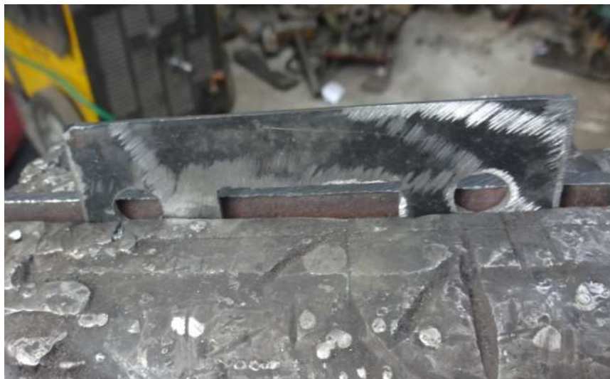
FIGURA 23: Desbaste del asiento de la cámara de combustión.
