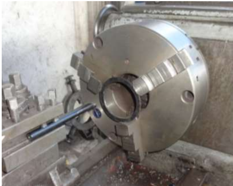
FIGURA 26: Torneado del anillo de la camisa de la cámara de combustión.
