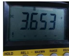
Figura 55. Medición del voltaje del cable señal del sensor APP
