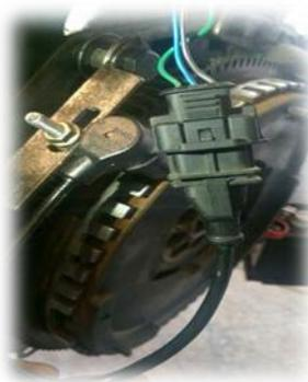
Figura 84. Conectores sensor CKP
