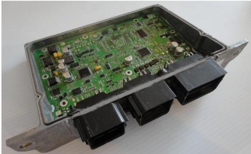
Figura 31. Estructura de una unidad de control
