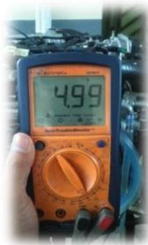
Figura 74. Prueba de control de alimentación
