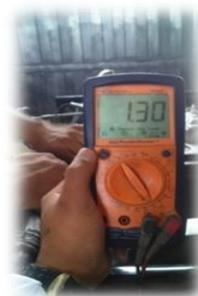
Figura 61. Medición del voltaje del cable señal del sensor FRP
