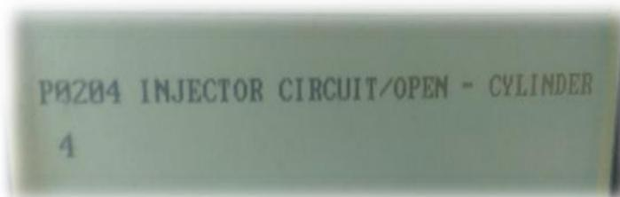
Figura 117. Código de falla del inyector N° 4
