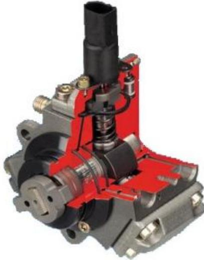
Figura 9. Bomba de alta presión
