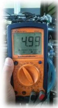
Figura 56. Prueba de control de alimentación
