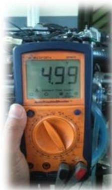
Figura 53. Medición del voltaje del cable de alimentación del sensor APP
