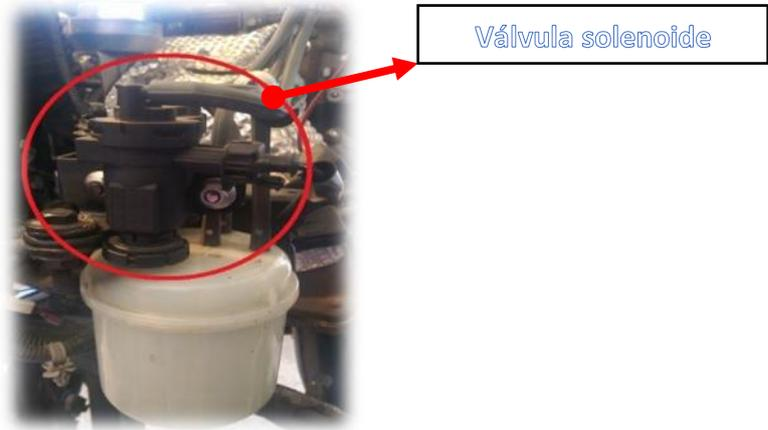
Figura 118. Válvula del solenoide de vacío
