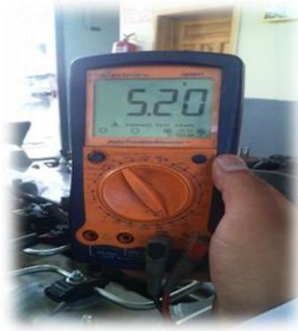
Figura 39. Medición alimentación sensor ECT
