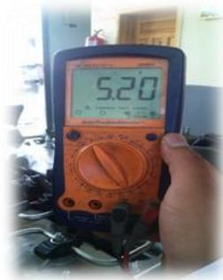
Figura 37. Medición del voltaje del cable de alimentación del sensor ECT
