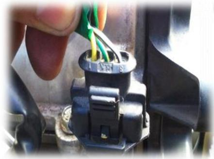
Figura 92. Terminales del sensor CMP
