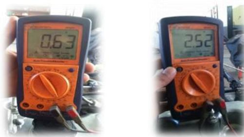
Figura 68. Medición del voltaje del cable señal del sensor MAF
