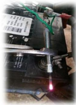
Figura 104. Prueba de bujía con tensión directa desde la batería
