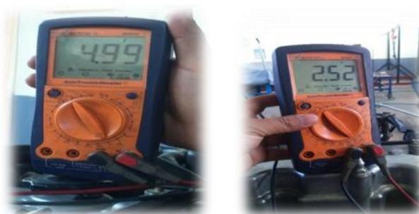
Figura 46. Medición del voltaje cable alimentación del sensor EFT
