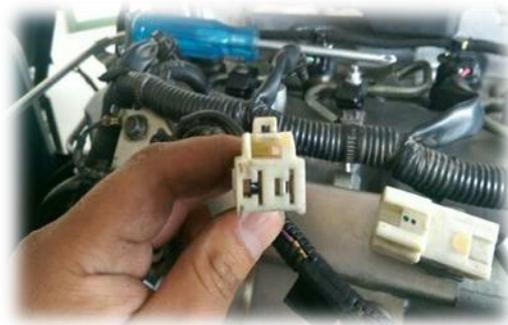
Figura 101. Terminales del conector de las bujías de pre calentamiento
