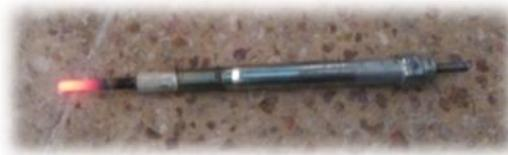
Figura 105. Bujía de precalentamiento
