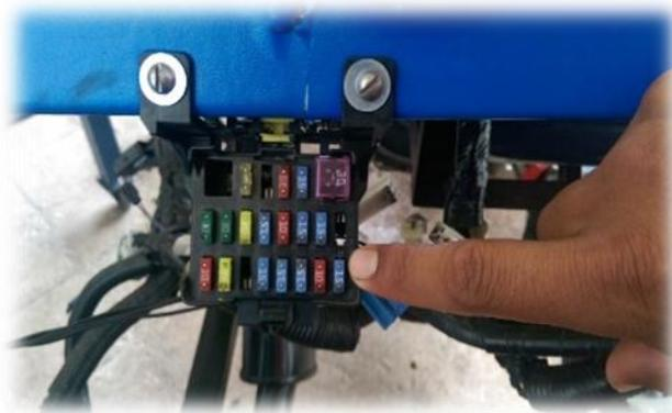
Figura 103. Fusible de las bujías de pre calentamiento
