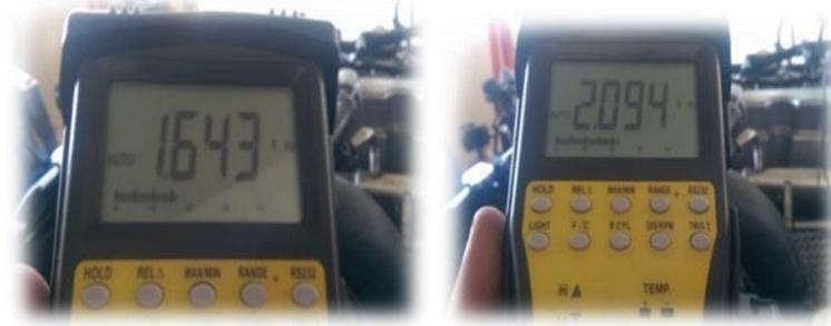
Figura 88. Medición de frecuencia CKP
