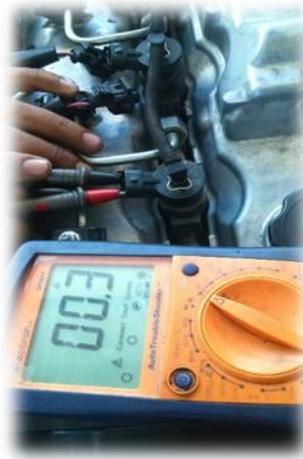
Figura 109. Medición de resistencia Inyector
