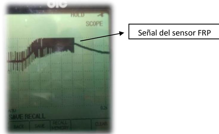
Figura 63. Curva del sensor FRP
