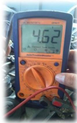
Figura 38. Medición del voltaje del cable señal del sensor ECT
