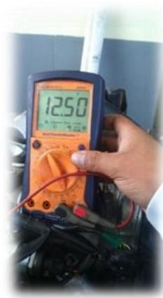
Figura 72. Medición del voltaje en el sensor IAT
