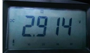
Figura 54. Medición del voltaje del cable señal del sensor APP
