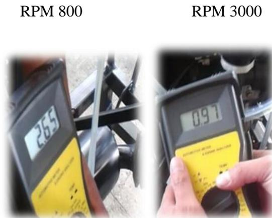
Figura 85. Medición resistencia sensor CKP
