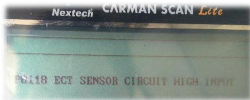
Figura 42. Código de falla del sensor ECT
