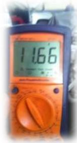
Figura 69. Prueba de alimentación del sensor MAF
