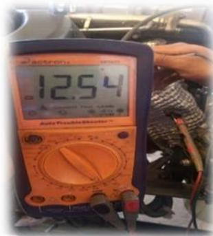
Figura 120. Voltaje válvula solenoide cable blanco
