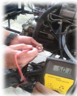
Figura 47. Prueba de alimentación del sensor EFT.
