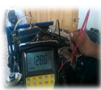
Figura 93. Medición de frecuencia CMP
