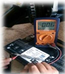
Figura 106. Prueba de resistencia de la bujía de precalentamiento
