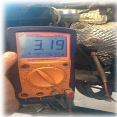
Figura 119. Voltaje válvula solenoide cable amarillo negro
