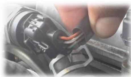
Figura 60. Terminales del conector, sensor FRP
