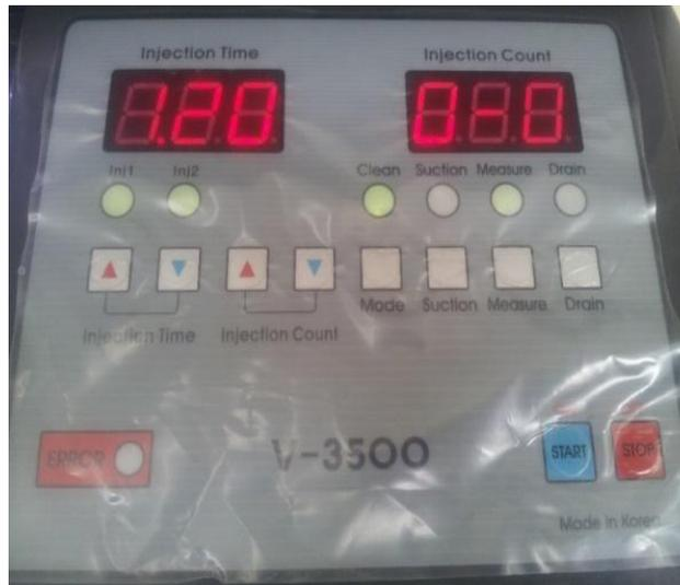
Figura 61. Parámetros de funcionamiento para la limpieza de los inyectores.
