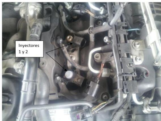
Figura 75. Desmontaje inyectores
