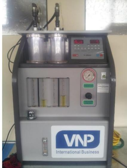
Equipo de diagnóstico MT – 3000 para inyectores electrónicos a diésel de motores CRD i.
