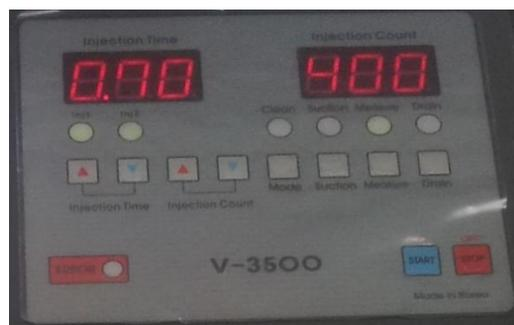
Figura 83. Parámetros de trabajo para la prueba de inyección principal.
