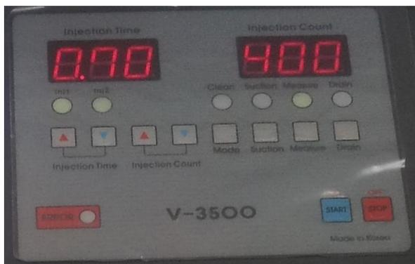
Figura 57. Parámetros de trabajo para la prueba de inyección principal.
