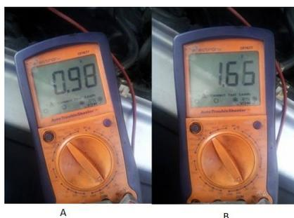
Figura 40. Voltajes del sensor de presión del riel
