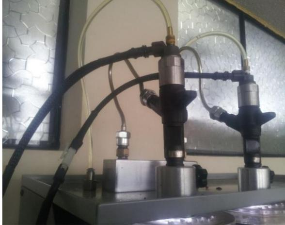
Figura 50. Instalación inyectoros banco de comprobación
