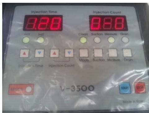
Figura 87. Parámetros de funcionamiento para la limpieza de los inyectores.
