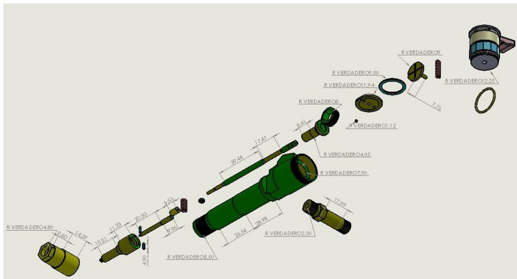
Figura 26. Partes inyector
