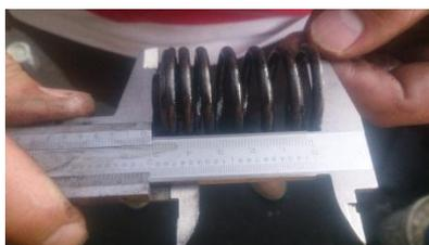
Figura 77. Medición de la longitud del muelle de válvula.
