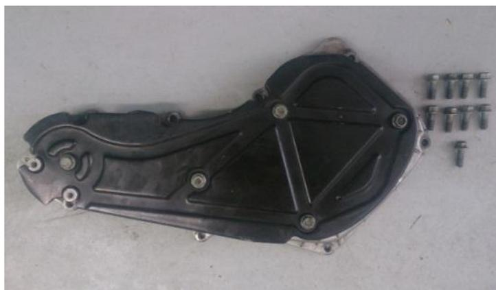
Figura 30. Cubierta superior frontal de la cadena de distribución C.
