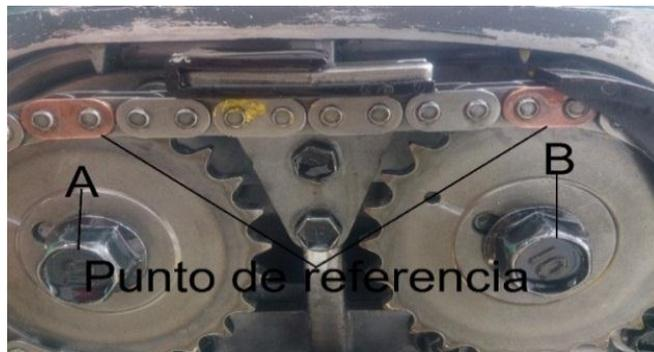
Figura 36. Ruedas dentadas del árbol de levas A y B
