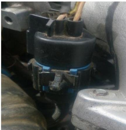
Figura 101. Sensor de refrigerante del motor
