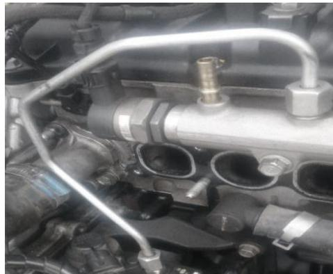
Figura 100. Cañería de la bomba de combustible de alta presión
