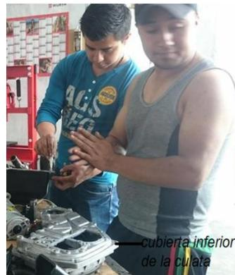
Figura 39. Cubierta inferior de la cadena de distribución A
