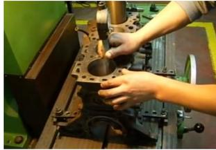
Figura 89.Medición del diámetro del cilindro
