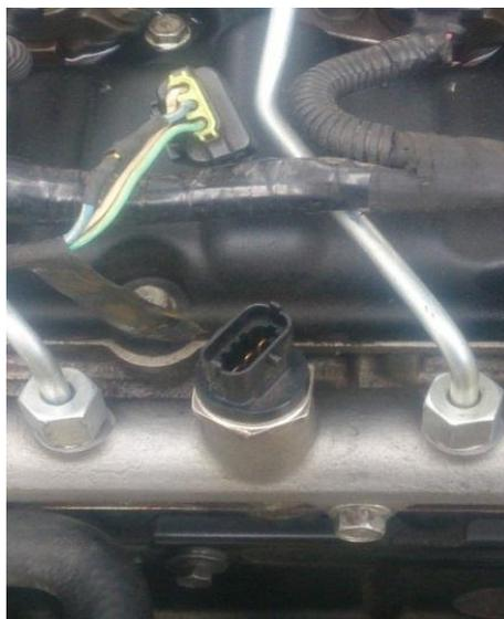
Figura 102. Sensor de presión del riel.
