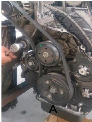
Figura 38. Polea del cigüeñal.
