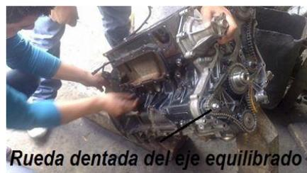
Figura 40. Rueda dentada del eje equilibrado.
