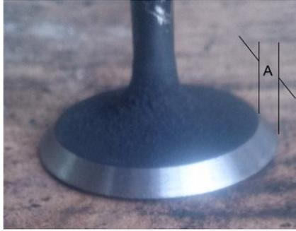
Figura 75. Comprobación del contacto del asiento de la válvula.
