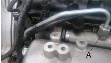
Figura 19. Cañería de combustible de alta presión
