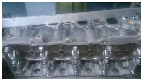
Figura 80. Reglaje de los colectores admisión y escape.
