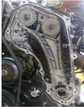
Figura 37. Cubierta trasera de la distribución.
