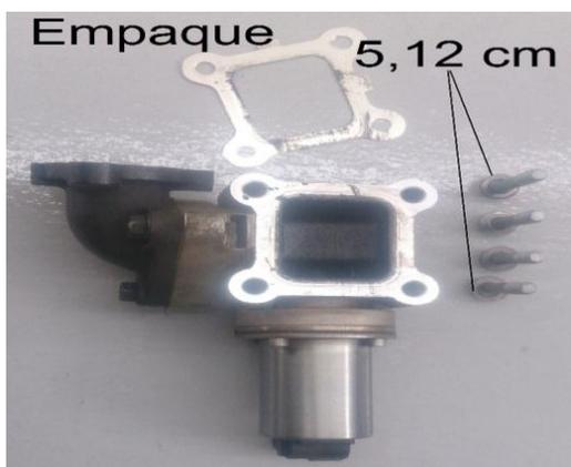
Figura 98. Válvula reguladora de gases de escape
