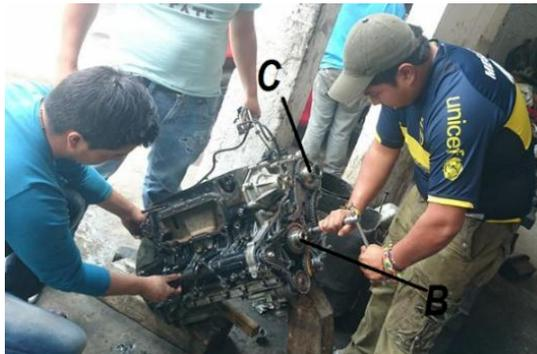
Figura 59. Desmontaje de la bomba de aceite.
