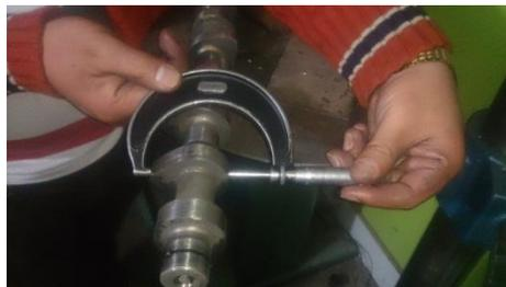
Figura 70. Calibración de lóbulos en el árbol de levas.
