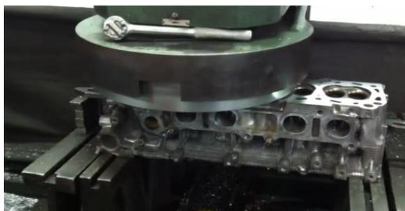
Figura 90.Rectificación del cabezote.
