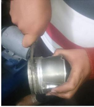
Figura 87. Comprobación del ancho de cada uno de los anillos.
