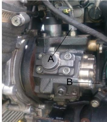
Figura 45. Bomba de combustible de alta presión.
