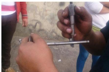
Figura 73. Medición de la longitud de la válvula.
