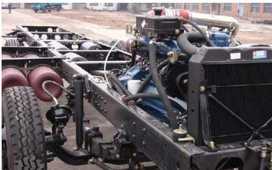
Figura4. Chasis o Bastidor 1
