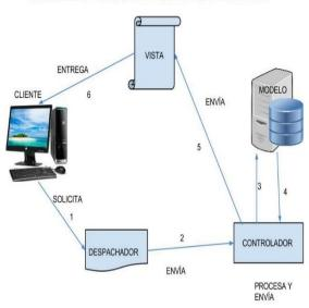
FUNCIONAMIENTO DE UNA PETICIÓN EN UN SISTEMA MVC
