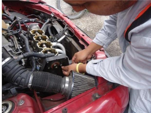
Figura 31. Desmontaje polea árbol de levas, banda y templador
