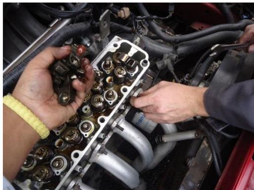
Figura 34. Desmontaje de balancines
