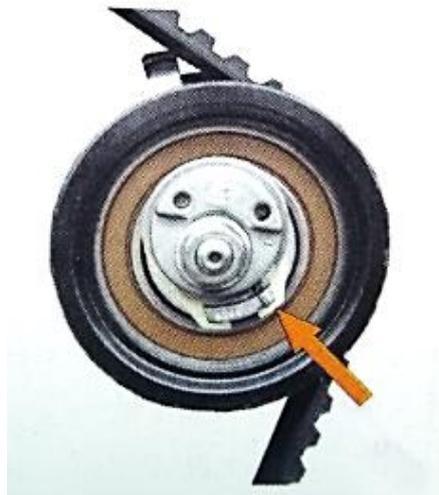
Figura 30. Tensor automático con marca de referencia
