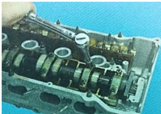
Figura 36. Desapriete de tornillos de fijación
