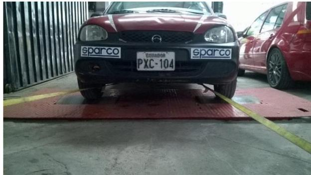
Figura 68. Corsa Wind 1.4L sobre rodillos del Banco Dinamométrico
