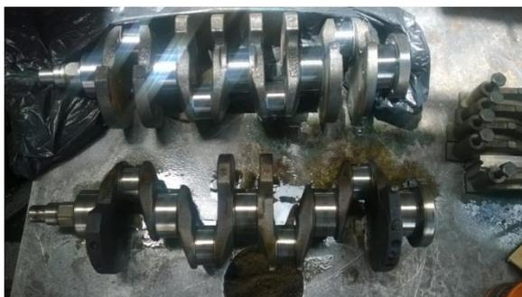
Figura 40. Cigüeñales. Comparación de cigüeñal antiguo con el cigüeñal nuevo
