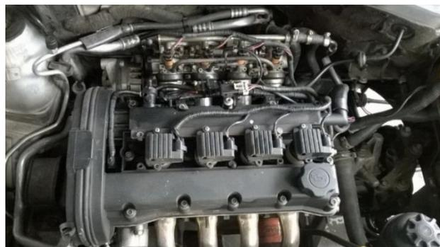
Figura 51. Culata Twin Cam con bobinas independientes
