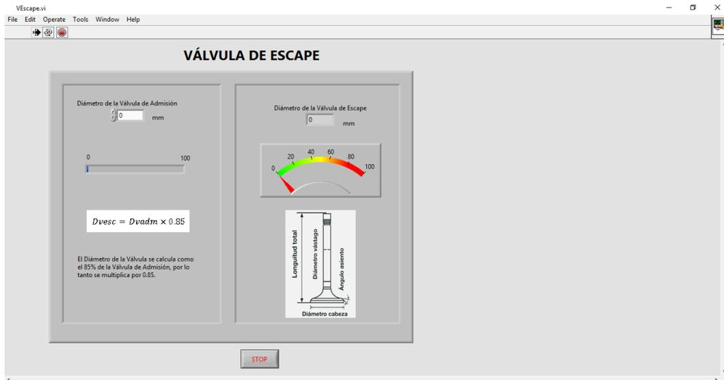
Figura 79. Cálculo de la válvula de escape
