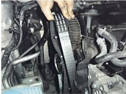
Figura 29. Sustitución de la correa dentada
