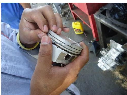
Figura 47. Colocación de rin de compresión
