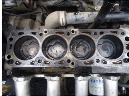
Figura 38. Desmontaje de la Culata
