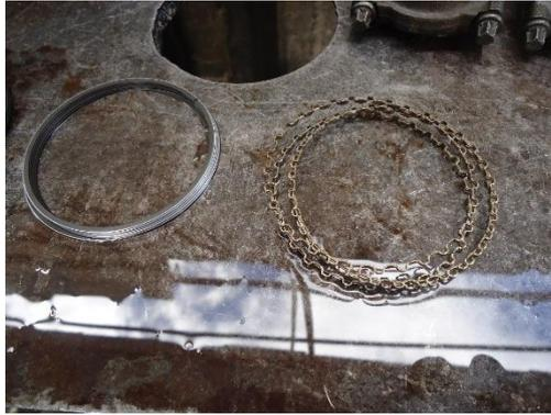
Figura 15. Rines o segmentos de un émbolo.
