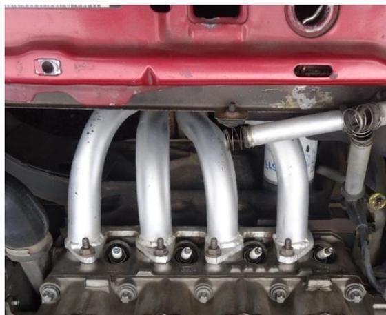
Figura 25. Header. Sistema de colector de gases de escape.
