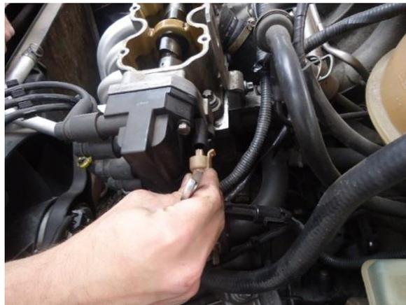
Figura 32. Desmontaje del distribuidor de encendido
