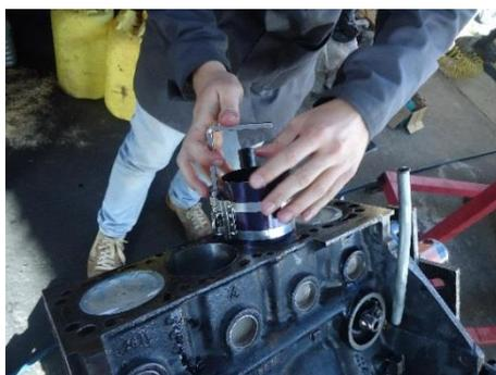
Figura 46. Colocación de pistones con la ayuda de un prensa-rines
