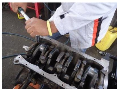
Figura 39. Desmontaje del cárter y cigüeñal
