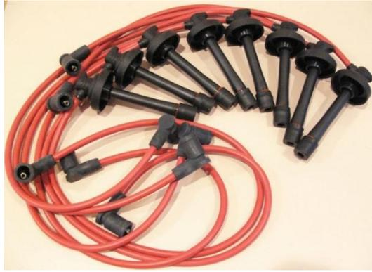
Figura 3. Cables de bujías.
