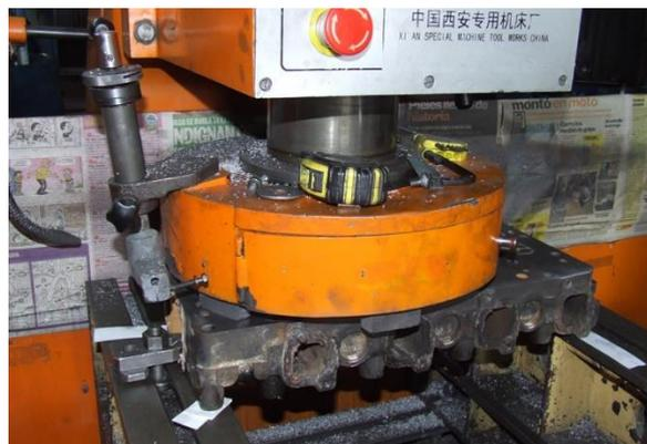
Figura 8. Rectificado de la culata por proceso de maquinado.
