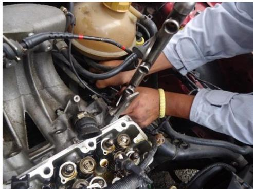
Figura 37. Desmontaje de mangueras y bomba de refrigeración
