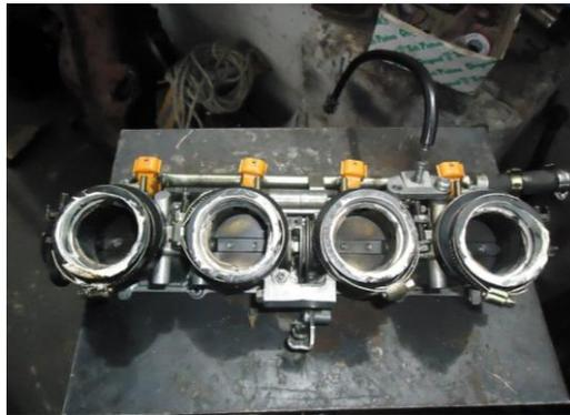
Figura 62. Sistema ITB cuatro cilindros con inyectores y flauta.
