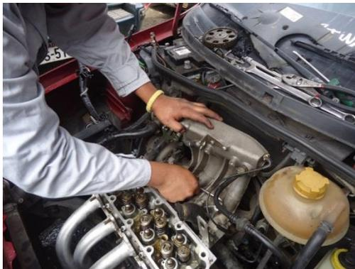
Figura 33. Desmontaje del sistema de admisión
