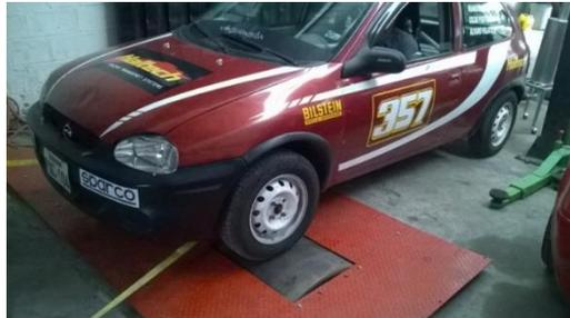
Figura 66. Corsa Wind 1.4L sobre rodillos del Banco Dinamométrico
