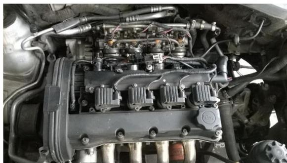
Figura 64. Culata con las bobinas independientes
