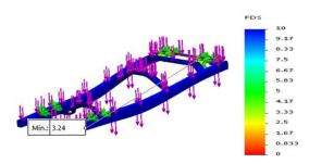
Figura. 5. Factor de seguridad.
