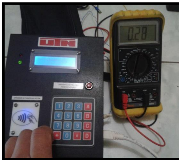
Figura 67: Medición de la corriente total del sistema.
