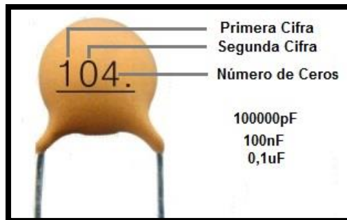
Figura 31: Capacitor cerámico 104.
