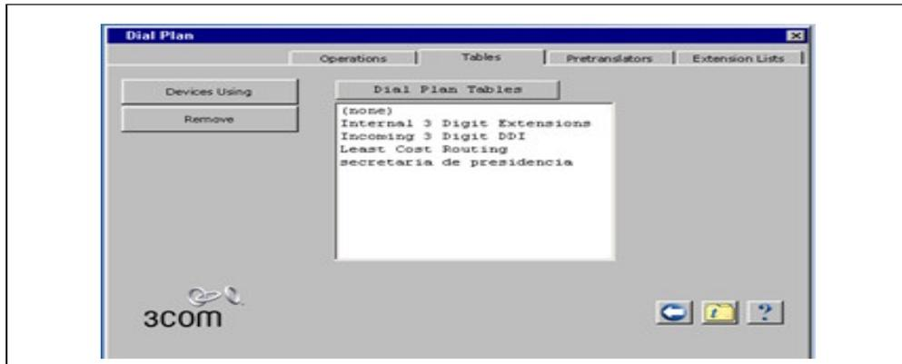
**Figura 3. 10:** Tablas existentes en el Dial Plan de la PBX
