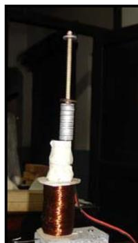
*Figura 6.8 Bobina construida manualmente*
