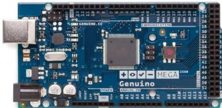
**Figura 6.** Placa Arduino Mega.
