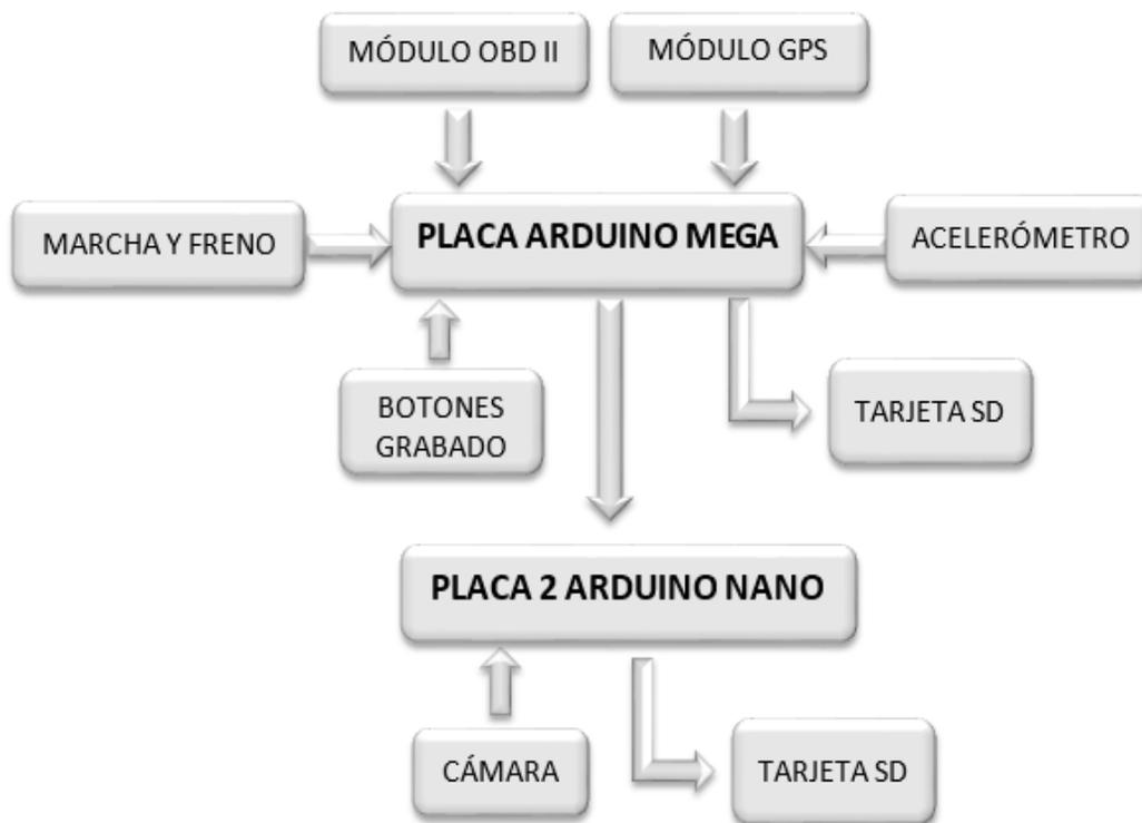
**Figura 23.** Diagrama de bloques (Módulo de almacenamiento de datos).
