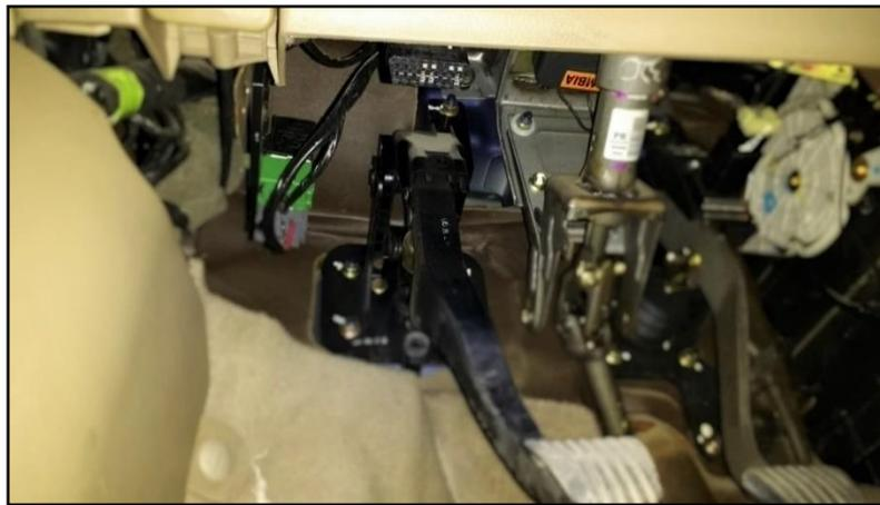
**Figura 3.** Ubicación del conector OBDII de 16 pines.
