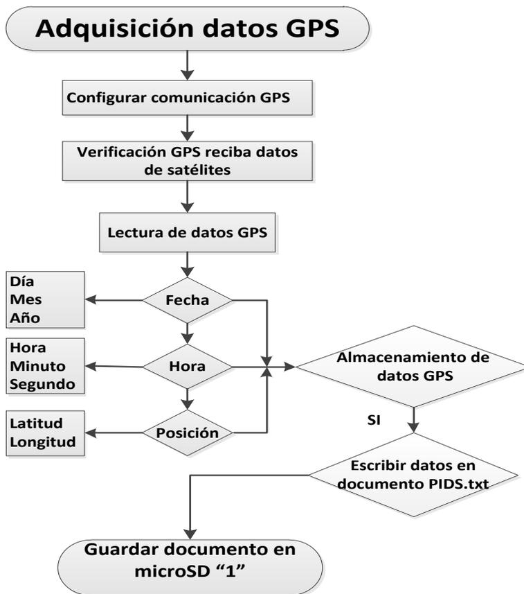
Figura 48. Flujograma de adquisición del GPS.
