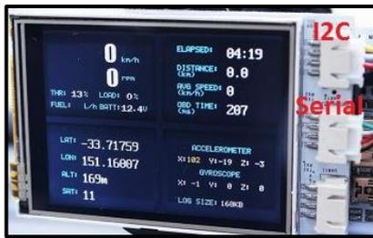
Figura2. Puertos de comunicación Shield
