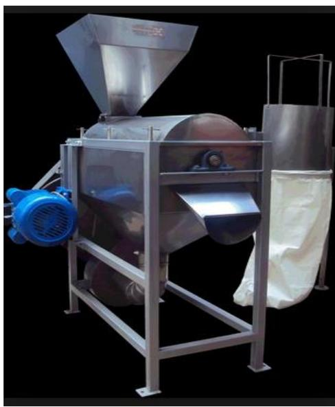
**4.- Secadora y enfriamiento.** - Elimina el porcentaje de humedad del grano de quinua del 30% al 11%, en un tiempo de una hora con cuarenta y cinco minutos. En la misma máquina se procede inmediatamente al proceso de enfriado que demora 20 minutos por carga.
