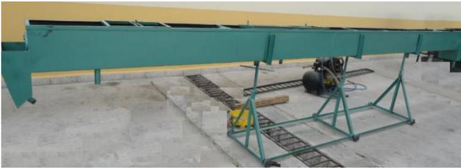
Figura 4. Tina de enfriamiento para la fabricación de mangueras
