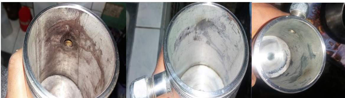
Figura 72: Manchado de paredes
