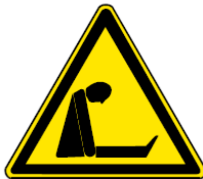
Figura 35. Aviso peligro de asfixia
