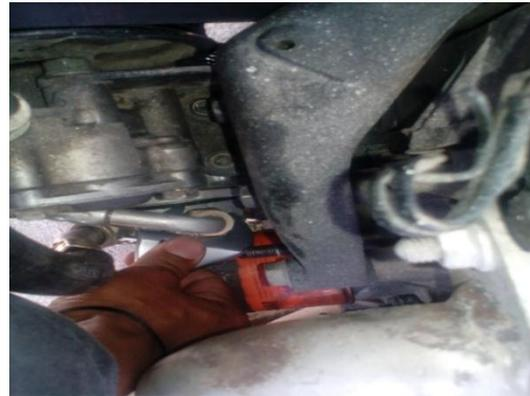
**FIGURA 0.2:** Manguera de descarga o carga
