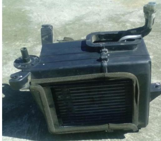
**FIGURA 0.1** Montaje del evaporador y acople
