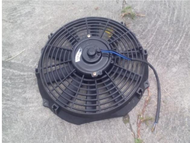
**FIGURA 3.7:** Electro ventilador
