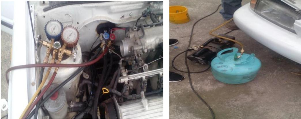
**FIGURA 3.39:** Verificación y carga
