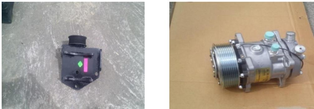
**FIGURA 3.4:** Compresor y la base de compresor
