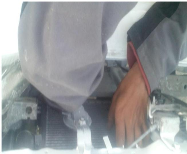
**FIGURA 3.27:** Montaje del condensador
