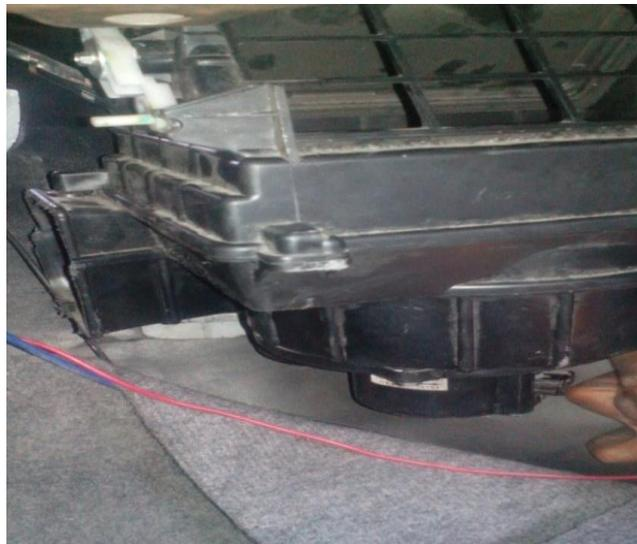
**FIGURA 3.29:** Montaje del blower
