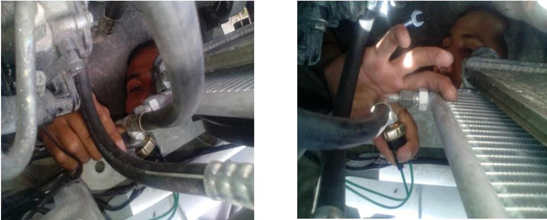
**FIGURA 3.35:** Presostato de presión
