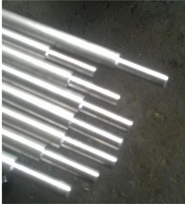
Figura 29. Extremos torneados de las varillas.
