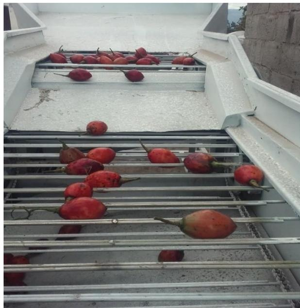
Figura 51. La fruta circulando por la banda transportadora.
