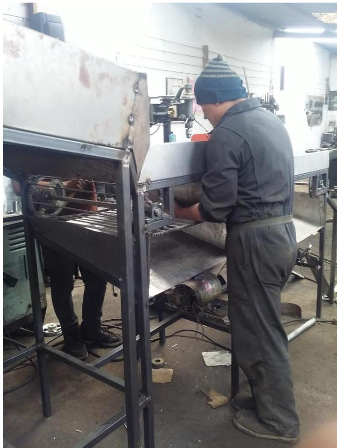
Figura 35. Recubrimiento de la máquina con la chapa metálica.
