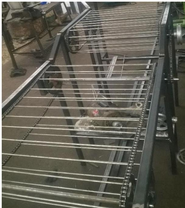
Figura 31. La banda transportadora implementada en la estructura.
