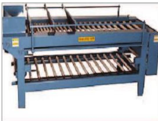
Figura 6. Máquina clasificadora de jitomates por tamaño (*Alcalde Cajamarca, 2013*).
