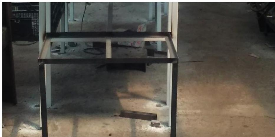
Figura 42. Construcción e implementación del marco para fijar las gavetas que reciben los tomates clasificados.
