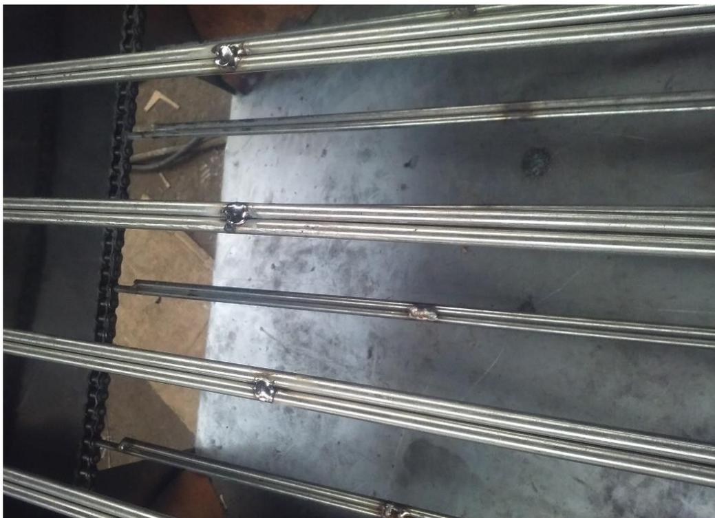
Figura 34. Reducción de la distancia entre las varillas soldando otra varilla en paralelo.
