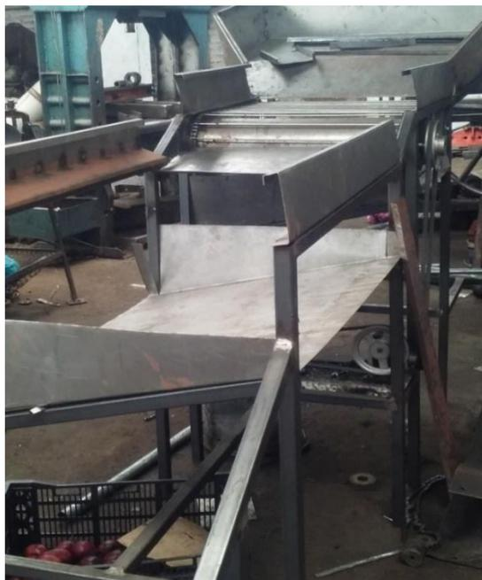
Figura 38. Construcción e implementación de la bandeja que recibe los tomates clasificados.
