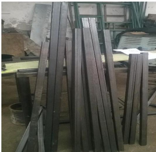
Figura 24. Cortes del tubo cuadrado para armar la estructura.
