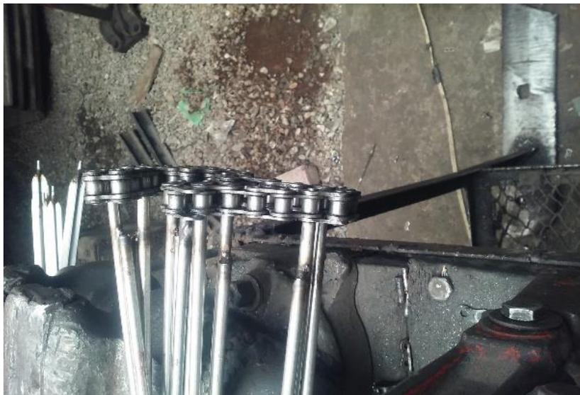
Figura 30. Ensamblaje de las varillas en la cadena.
