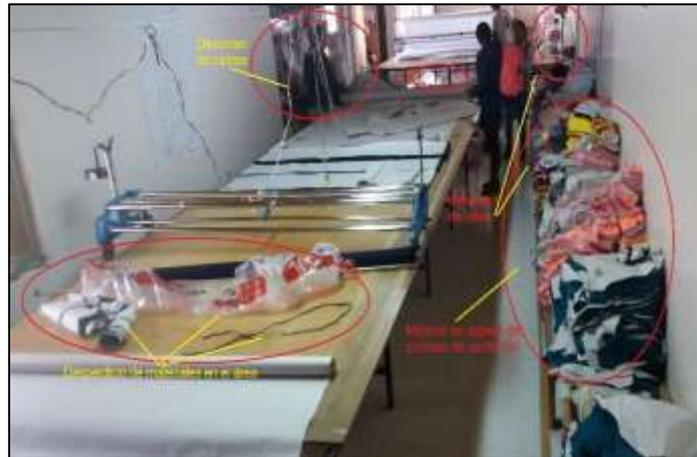
**Ilustración 12.** Evidencia de deficiencia 5S's en corte.
