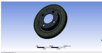
**Figura 6** Mallado del disco de freno
