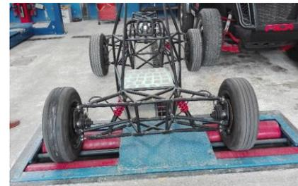
**Figura 14** Prueba de frenado en frenómetro
