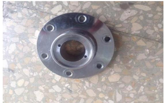
Figura 14. Acople del volante.
