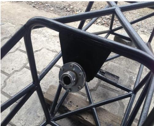
Figura. 1. Base de la columna de dirección
