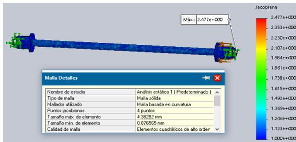
Figura 8. Análisis de malla en la columna.
