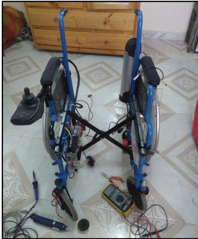
4. Pruebas de funcionamiento del joystick.
