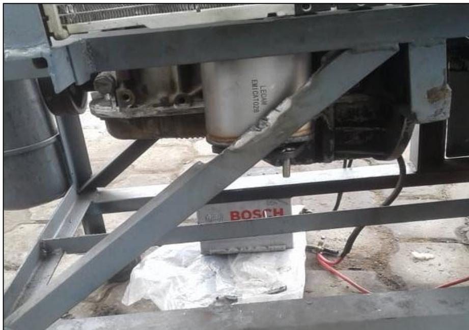
**Figura AIV.2** Convertidor catalítico instalado en el banco motor.
