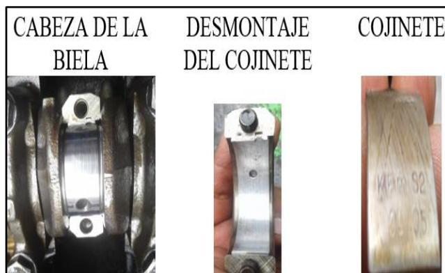
**Figura 2.8** Verificación de los cojinetes de fricción de la biela.
