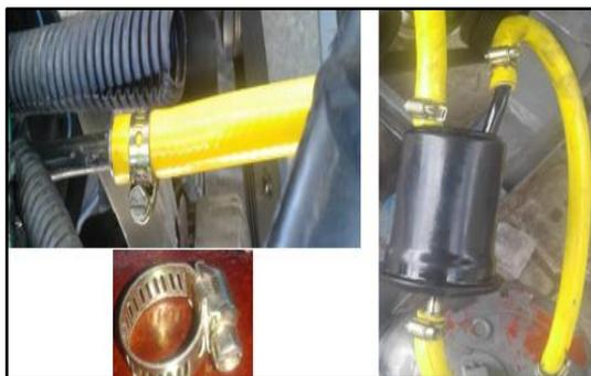
**Figura 2.19** Verificación de mangueras y cañerías.
