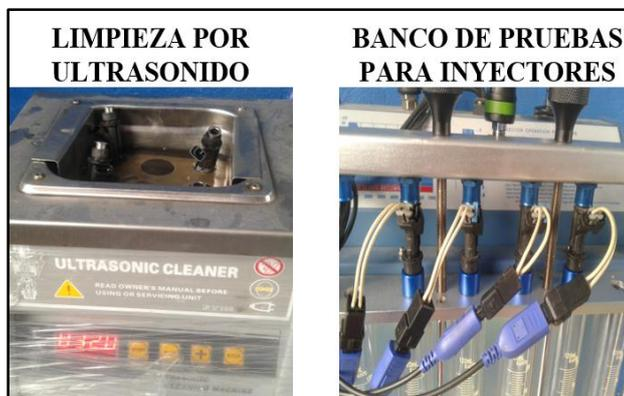
**Figura 2.17** Limpieza y prueba de inyectores por ultrasonido.
