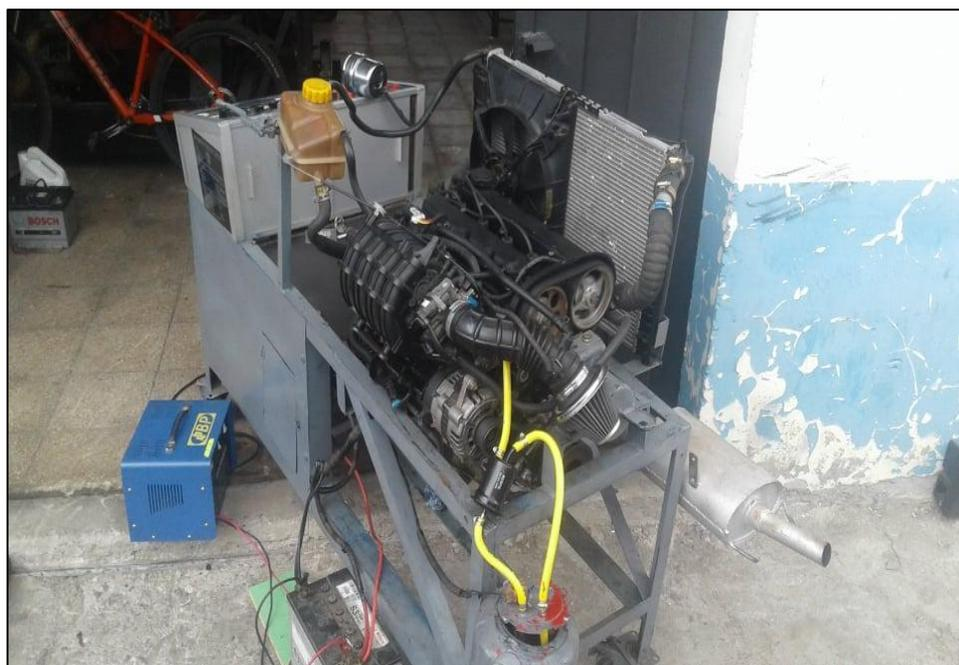
**Figura AVI.2** Banco motor conectado los equipos de medición.
