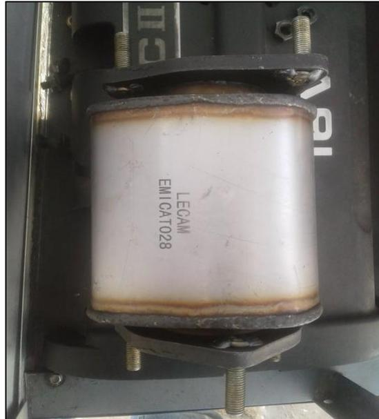
**Figura AIV.1** Convertidor catalítico para el Aveo activo 1.6
