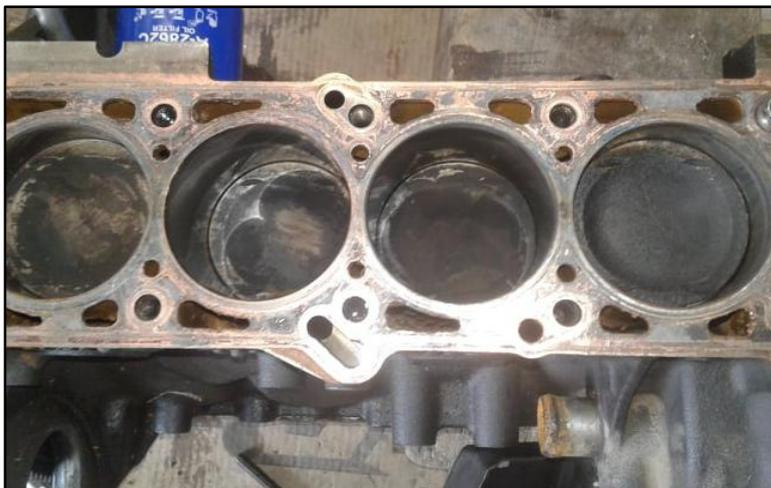
**Figura AII.2** Desmontaje del bloque de cilindros y culata.
