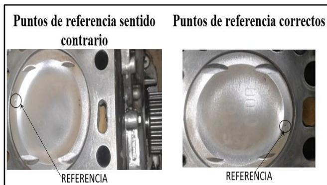
**Figura 2.10** Puntos de referencia para la ubicación del pistón.
