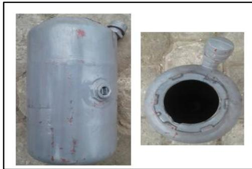
**Figura 2.14** Depósito de combustible.
