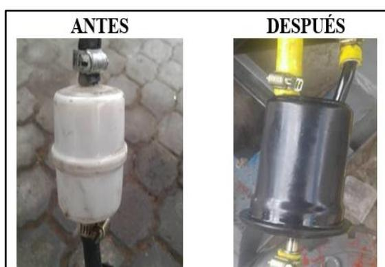
**Figura 2.13** Verificación del filtro de combustible.
