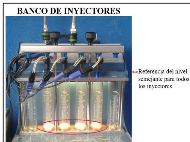
**Figura 2.18** Pruebas realizadas en el banco de inyectores.
