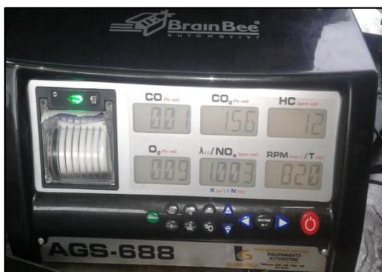
**Figura 2.2** Analizador de Gases Brain Bee AGS-688
