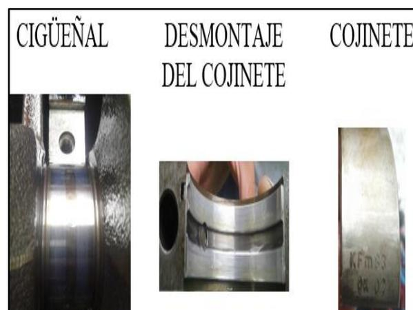
**Figura 2.6** Verificación del estado de los cojinetes de fricción y del cigüeñal.
