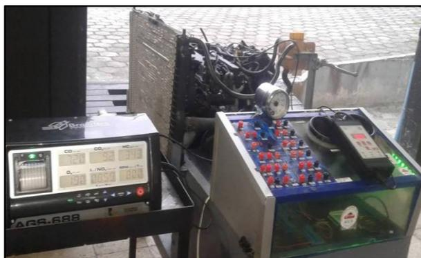
**Figura 2.22** Banco motor conectado a los equipos de medición.
