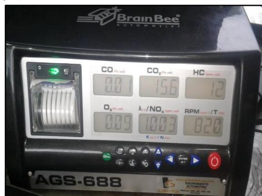
**Figura 2.** Analizador de Gases Brain Bee AGS-688.
