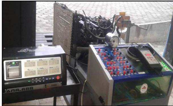
**Figura 5.** Banco motor conectado a los equipos de medición.
