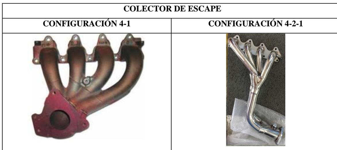
**Figura 2.1** Configuraciones del colector de escape
