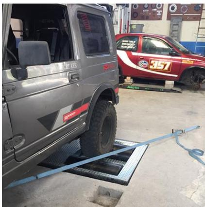
**Figura 2.5** Colocación de correas de seguridad
