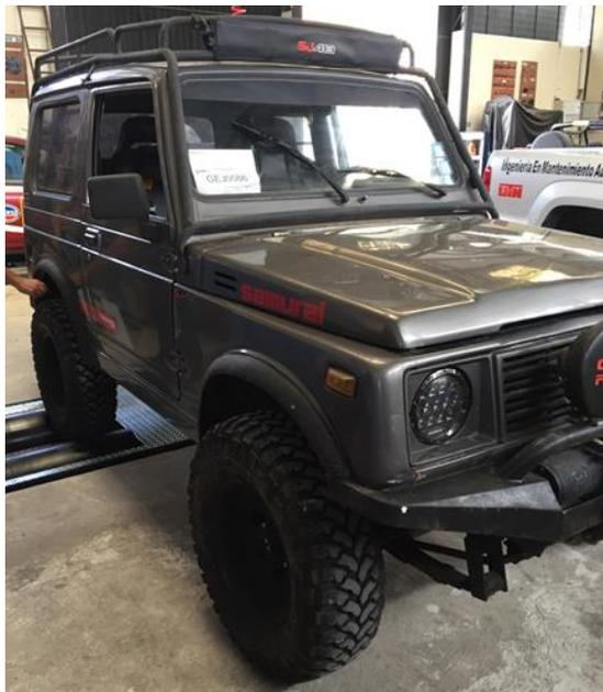
**Figura AI.1** Montaje del vehículo en el dinamómetro
