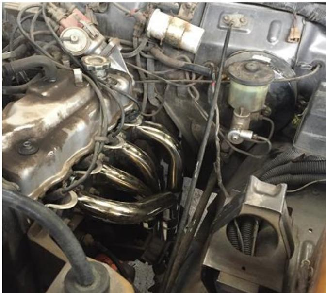
**Figura AV.5 Configuración (4-2-1)**
