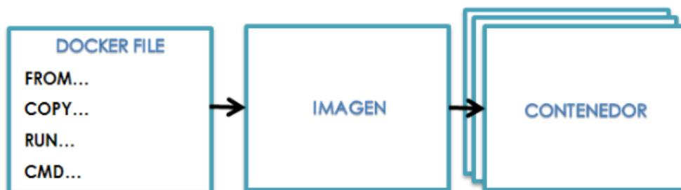
Fig. 20. Proceso de construcción de un contenedor
